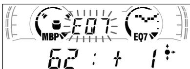
Чтобы восстановить кривую эквалайзера, установленную на заводе-изготовителе, нажмите на 2 секунды кнопку **(ENTER)**.
