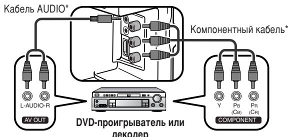
При использовании кабеля преобразования HDMI-DVI подавайте входной аудиосигнал на AUDIO гнезда EXT5.
