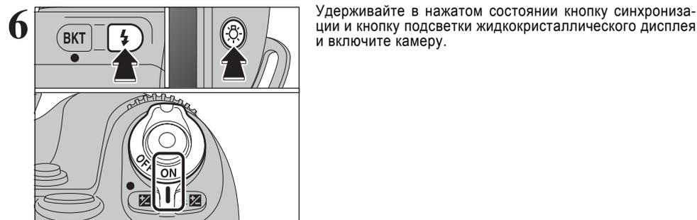
Удерживайте в нажатом состоянии кнопку синхронизации и кнопку подсветки жидкокристаллического дисплея и включите камеру.
