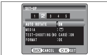
С помощью этой функции камера определяет свое положение (горизонтальное или вертикальное), чтобы при открывании изображений в дополнительном программном обеспечении (например, в программе Hyper-Utility Software HS-V2, версия 3.0) изображения автоматически поворачивались.
