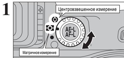
Установите селектор системы измерения в положение, соответствующее матричному или центровзвешенному измерению.
