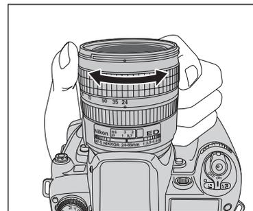
Сфокусируйте камеру, поворачивая кольцо фокусировки на объективе до тех пор, пока изображение на матовой поверхности экрана видоискателя не станет четким.
