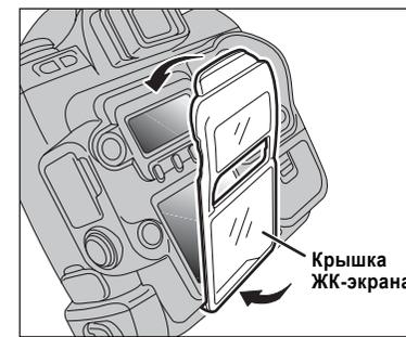
Чтобы предотвратить загрязнение или повреждение экрана жидкокристаллического монитора, при переноске или, когда Вы не пользуетесь фотокамерой, устанавливайте на ЖК-монитор защитную крышку. Устанавливайте крышку, сначала вставив ее в пазы под ЖК-монитором фотокамеры.
