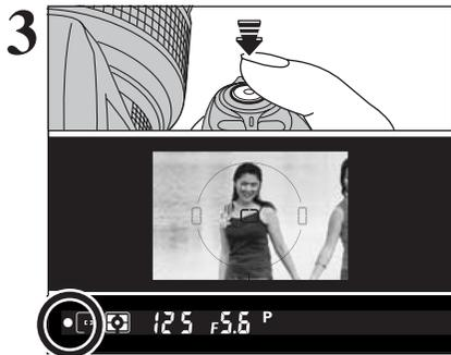
Удерживайте кнопку спуска затвора в нажатом до половины состоянии (фикс-фокус) и убедитесь в том, что на дисплее видоискателя начал светиться индикатор фокусировки «●».
