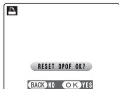
Если кадр содержит параметры DPOF, которые были определены на другой камере, на ЖК-мониторе отобразится сообщение «RESET DPOF OK?». Нажатие на кнопку MENU/OK приводит к стиранию всех параметров DPOF, установленных для каждого снимка (файла). После этого Вы должны вновь определить параметры DPOF для каждого кадра.
