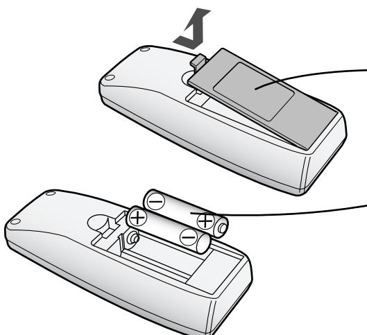
**1 Снимите заднюю крышку**
