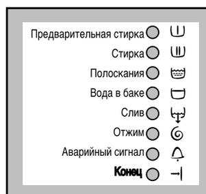
Лампа Аварийного сигнала ⓘ мигает, если возникает неисправность стиральной машины. Одновременно с этим мигает одна из следующих ламп, а код ошибки на универсальном дисплее показывает тип ошибки.
