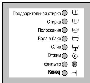
Лампа конца цикла мигает, если возникает неисправность стиральной машины. Одновременно с этим мигает одна из следующих ламп, а код ошибки на универсальном дисплее показывает тип ошибки.
