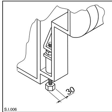
Установить направляющие (Н) на внутреннюю поверхность дверцы шкафа, как показано на рисунке, и отметить положение наружных отверстий. Подготовив отверстия, необходимо установить направляющие при помощи винтов 3,5x16 мм на дверь шкафа.
