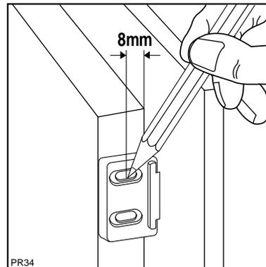
Снять кронштейны и выполнить отверстия сверлом диам. 2 мм. Вновь установить кронштейны на направляющие и привинтить их входящими в комплект винтами (3,5x16 мм). Для выравнивания двери шкафа можно воспользоваться ходом винтов в прорезях. После выполнения операции необходимо убедиться в плотности закрытия двери прибора.
