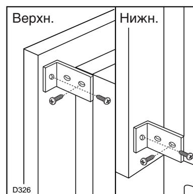
Прикрепите прибор к столешнице или к боковым панелям с помощью фиксирующих скоб (E). Затем между холодильником и прилегающими панелями мебели проложите ленту уплотнителя.
