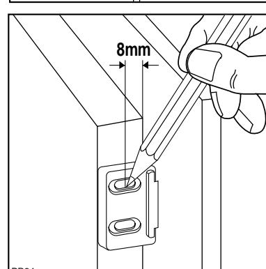
Снять кронштейны и выполнить отверстия сверлом диам. 2 мм.
