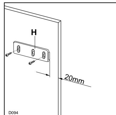
Открыть дверь прибора и дверь шкафа на 90°. Установить кронштейны над направляющими. Удерживать вместе дверь прибора и шкафа и отметить положение отверстий.
