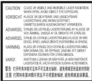
Приемное устройство классифицируется как ЛАЗЕРНЫЙ продукт КЛАССА 3R. Если защитный корпус лазера открыт, формируется видимое и невидимое лазерное излучение, поэтому избегайте прямого воздействия на глаза. Эта маркировка расположена на защитном чехле лазера внутри корпуса.
