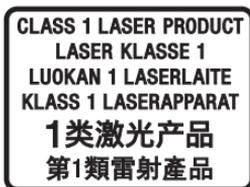
Это устройство классифицируется как ЛАЗЕРНЫЙ продукт КЛАССА 1. Эта маркировка расположена сзади. Фирменная табличка расположена внизу.
