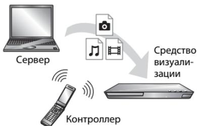
Управляйте этим модулем с помощью DLNA-контроллера. Изучите руководство, поставляемое с DLNA-контроллером.
