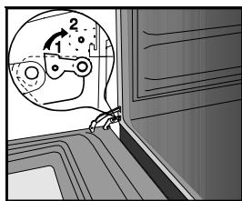
1 Петля дверцы при нормальном использовании
