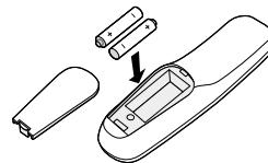
Вставьте поставляемые в комплекте телевизора 2 батарейки типа R6. Батарейки должны были установлены с правильной полярностью.
