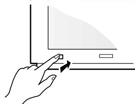
Для включения телевизора нажмите кнопку Вкл./Выкл. Загорается красный световой индикатор, и экран освещается. Переидите на стр. 4. Если телевизор находится в режиме ожидания, нажмите кнопку **P +** на пульте дистанционного управления. Когда вы пользуетесь пультом дистанционного управления, мигает световой индикатор.
