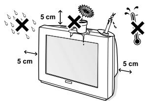
Установите телевизор на твердую и устойчивую поверхность. Во избежание возникновения опасных ситуаций не подвергайте телевизор воздействию воды и не накрывайте его ничем сверху (например, салфеткой), не ставьте на него наполненные жидкостью сосуды (например, вазу) и выделяющие тепло устройства (например, лампу).
