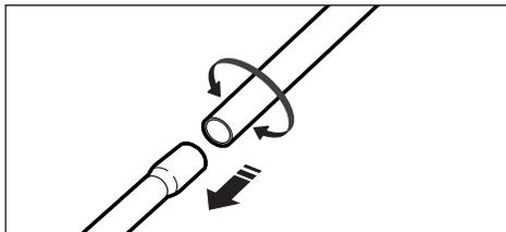
3) Наденьте насадку на трубку всасывания.
