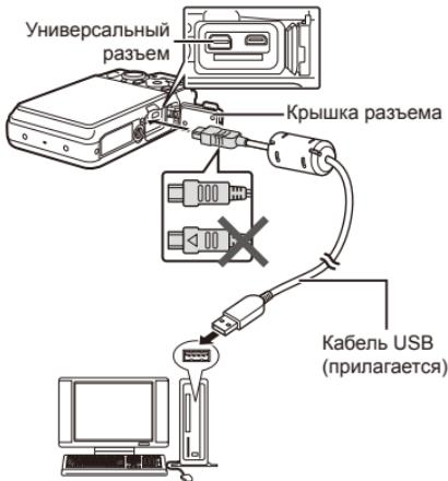
Когда параметр [USB Соединение] установлен на [Авто], подсоедините камеру к компьютеру, выберите [Хранение] или [MTP] на экране выбора способа подключения, затем нажмите кнопку .
