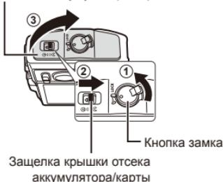
**Прежде чем открывать крышку отсека аккумулятора/карты, выключите фотокамеру.**
