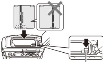
Ручка фиксатора аккумулятора
