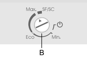
Чтобы включить прибор, поверните ручку В в направлении к Max. Чтобы выключить прибор, установите ручку так, чтобы знак треугольника на ручке был в положении  $\emptyset$  (прибор выключен, но находится под напряжением).
