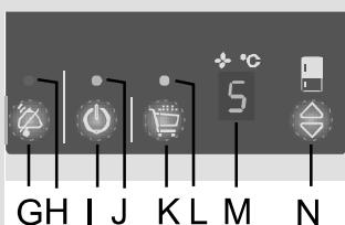
При первом включении сначала вставьте вилку сетевого кабеля в розетку. На дисплеях высветятся штрихи, которые означают, что холодильное и морозильное отделения выключены.
